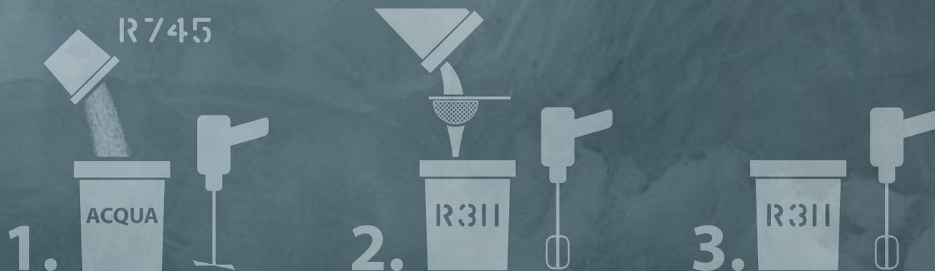
In un recipiente contenente l'intera quantità di acqua necessaria all'impasto del prodotto **R311** CEMENTO MADRE FINE (30 - 40% in peso) versare la polvere colorante **R745**. Agitare meccanicamente la sospensione acquosa colorata, fino ad ottenere una buona omogeneità della miscela.
